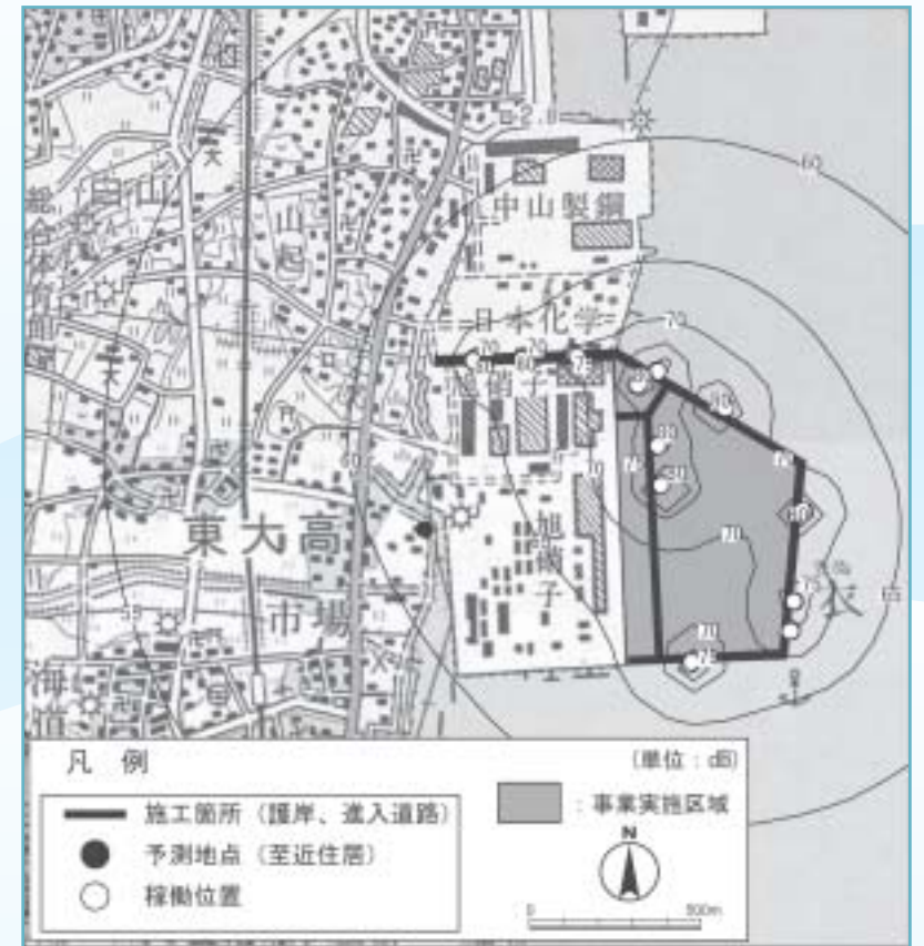
騒音の予測結果（L 5 ）（建設機械・作業船の稼働）
