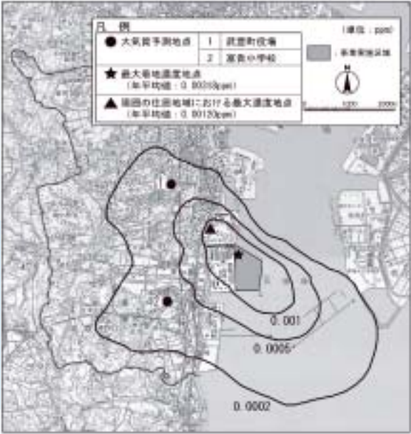
二酸化窒素(年平均値)の予測結果(建設機械・作業船の稼働)
